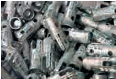
Figure 59 : Exemples de pièces parachevées par grenailage
