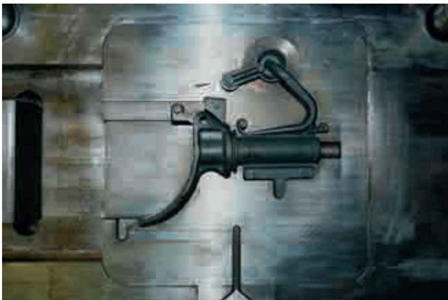
Figure 30 : partie fixe avec piece dans le moule
