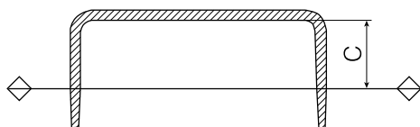
Figure 49 : Tolérances pour des dimensions limitées par le plan de joint
