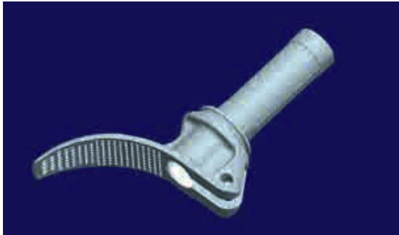
Figure 17 : Vue 3D de la pièce en Zamak
