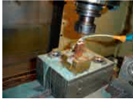
Figure 26 : Réalisation de l'électrode en fraisage 3D
