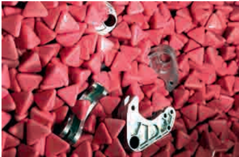
Figure 58 : Pièces parachevées par tribofinition
