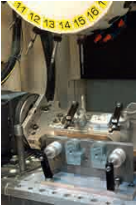
Figure 76 : Usinage sur machine à commande numérique
