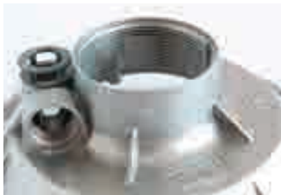
Figure 71 : Taraudage d'un diamètre 42 mm
