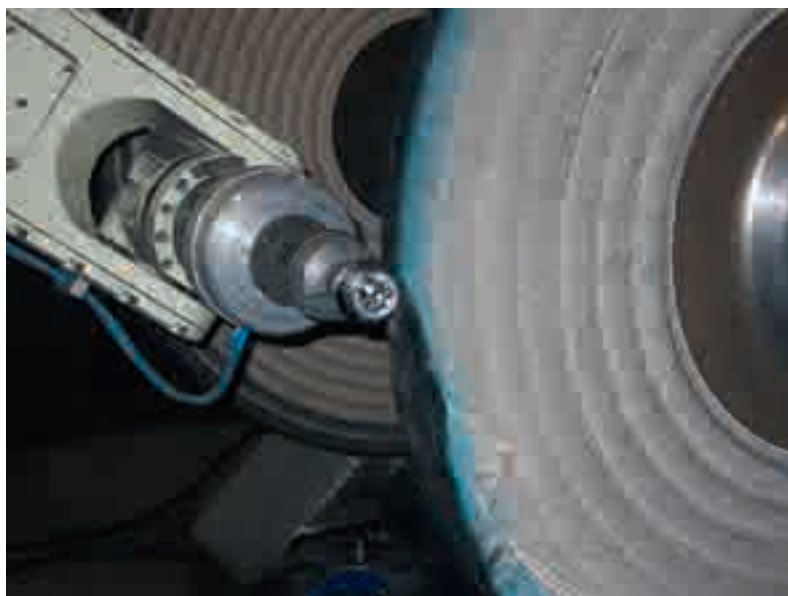
Figure 60 : Polissage par robot
