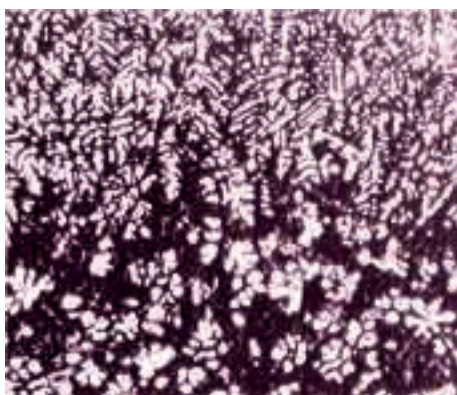
Figure 32 : Coupe micrographique mettant en évidence la peau de fonderie qui se caractérise par une plus grande finesse de structure (partie supérieure de la photo)
