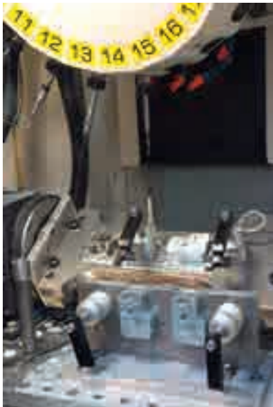
Figure 64 : Utilisation du 5ème axe pour usinage sur machine à commande numérique
