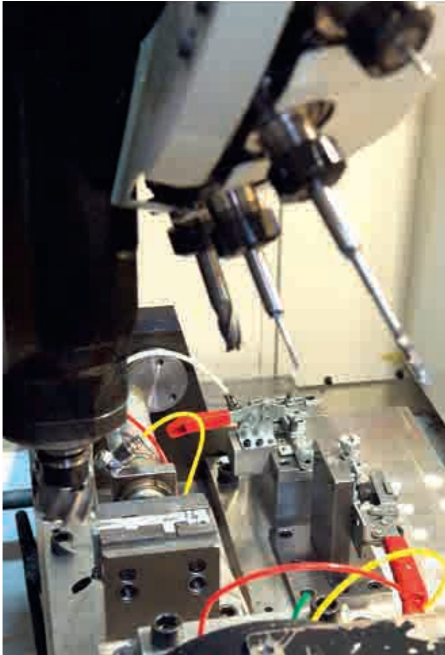
Figure 63 : Bridage pneumatique de pièce à aléser
