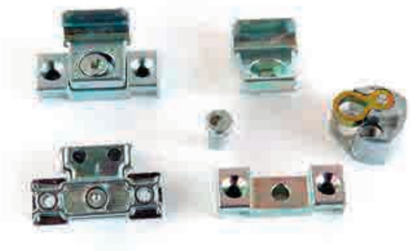
Figure 90 : Pièces assemblées par sertissage
