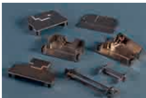
Figure 84b : Pièces cuivrées, nickelées et étamées
